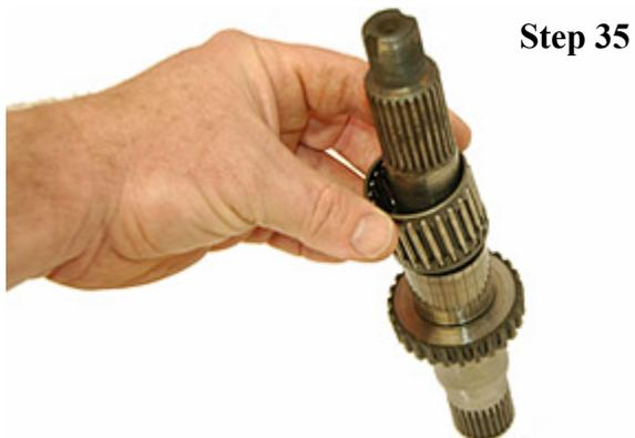
ケージベアリングを取り外します。ケージベアリング、シャフト、ハウジングを掃除します。
