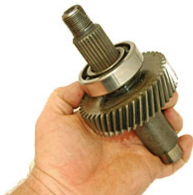
外側のベアリングを取り外したあと、内側のベアリングを押し出します。
