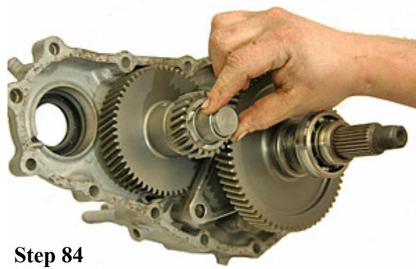
図のようにベアリングスペーサーを取り付けます。
