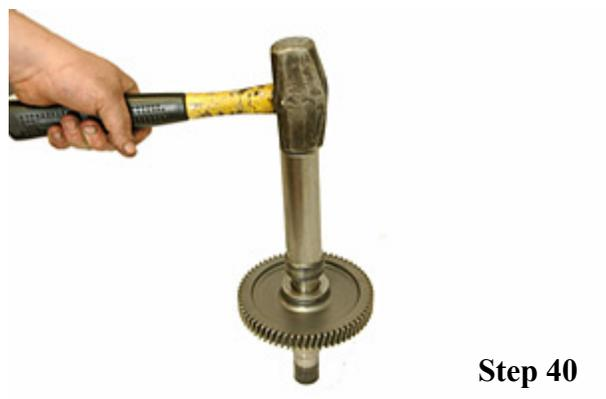
金属チューブなどをあてがい、ドライブギアをハンマーで押し込みます。
