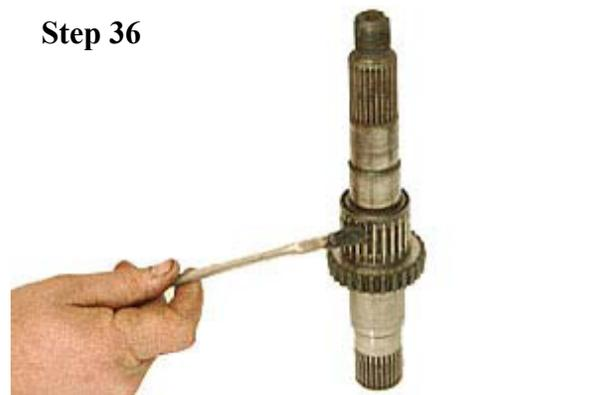
ケージベアリングをアウトプットシャフトに再び取り付けます。
