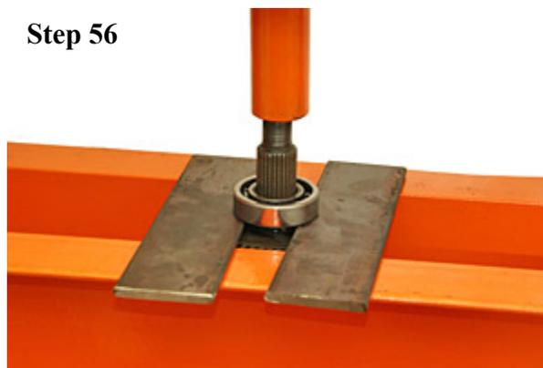
およそ6mm程度の厚さの鉄板を図のように使えば、インプットギアおよびベアリングのシャフト末端にあるドライブフレンジへの取り付けを円滑に行うことができます。
