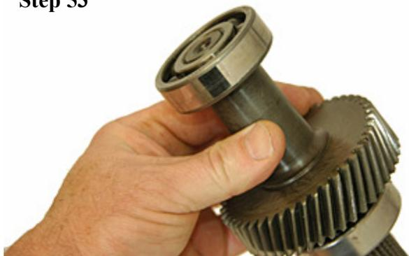
インプットシャフト両端のベアリングを取り外します。
