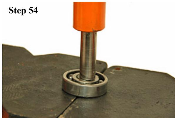
ベアリングを取り外す際、シャフトより小さめのソケットレンチ (14mmドライブソケットレンチ) を使うことを推奨します。
