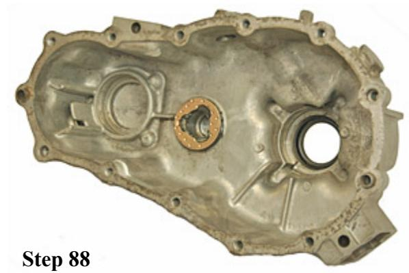
新しいカウンターシャフトメタルをリアハウジングの穴に取り付けます。注意: タブが図のようにハウジングの凹凸に合っているか確認してください。
