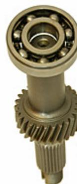
図のようにベアリングをシャフト末端に取り付けます。
