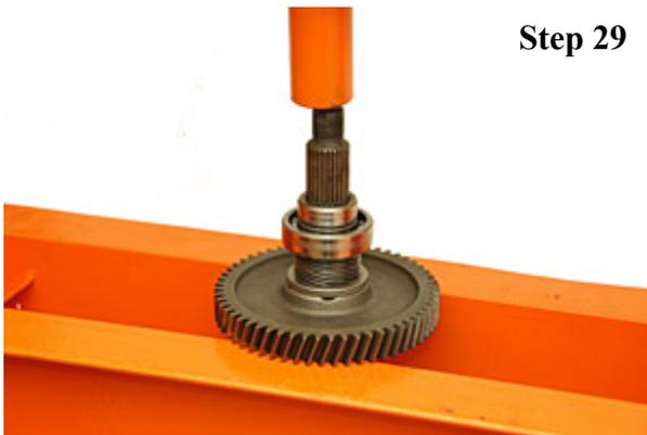
ギアアセンブリを裏返し、アウトプットシャフトをロースピードギアに押し込みます。
