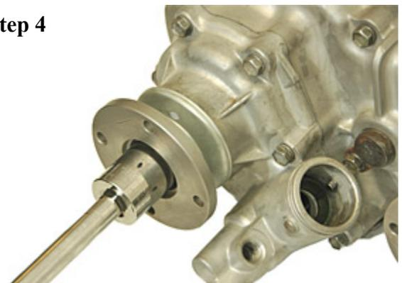
28mmのソケットレンチを使い、3個すべてのフランジナットとフランジを取り外します。場合によってはベアリングプーラーでフランジを引き抜く必要があります。
