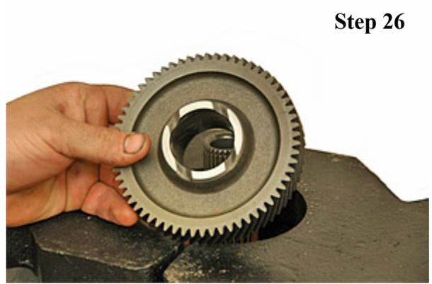
ハイスピードアウトプットギアを取り外します。
