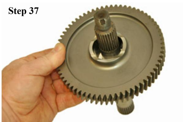
アウトプットギアに新しいロースピードギアを取り付けます。
