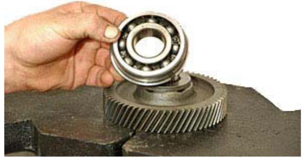
アウトプットのベアリングを取り外します。
